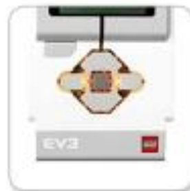
Индикатор состояния модуля – Оранжевый
