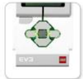
Индикатор состояния модуля – Зеленый
