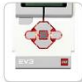
Индикатор состояния модуля – Красный
